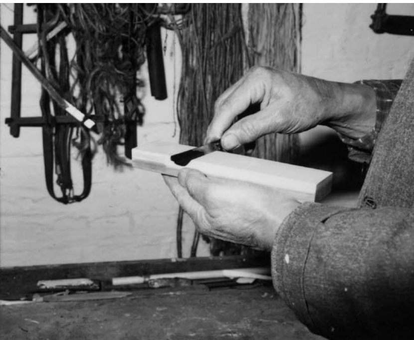
Effilage d'un rasoir manuel au moyen d'une pierre à rasoir. Photo André Lejeune, fin des années 1970. Collection privée.
