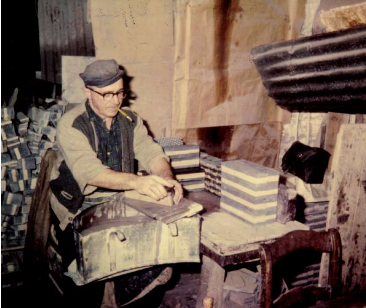
Monsieur Henri Nizette occupé au travail de douçissage de pierres à aiguiser de grande dimension (1967). Archives du Musée du Coticule.
