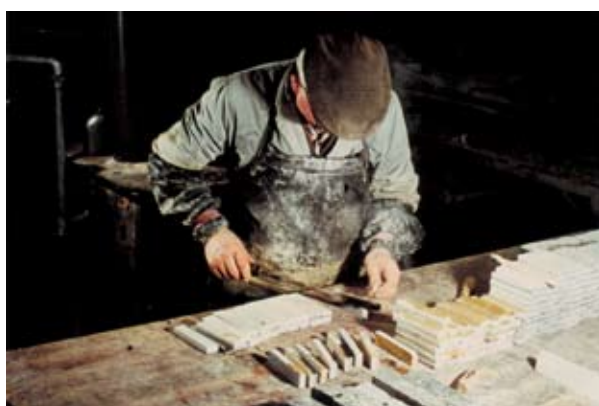
Opération de collage au fer des pierres à aiguiser réalisée par Joseph Minet. Photo A. Lejeune. Archives du Musée du Coticule.
