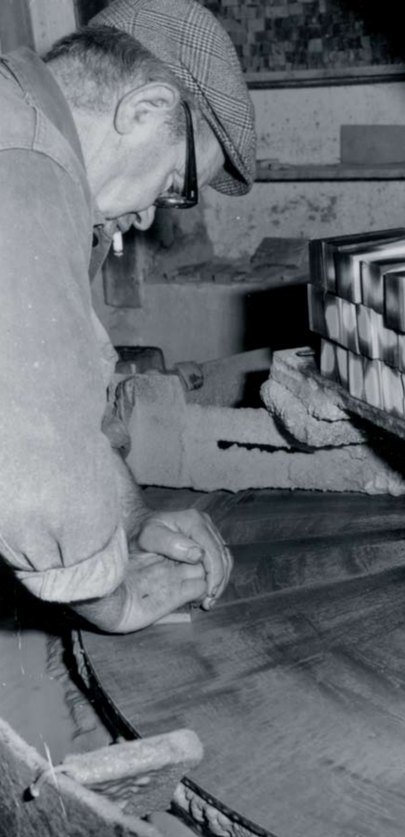
Polissage des pierres de coticule au lapidaire. La plaque de fonte tourne autour d'un axe vertical. La pierre est polie au moyen de sable mélangé à l'eau. Monsieur Collignon, Atelier Burton à Sart. Photo non datée. Photo A. Lejeune. Collection privée.
