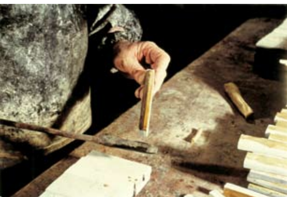
Opération de collage au fer des pierres à aiguiser réalisée par Joseph Minet. Photo A. Lejeune. Archives du Musée du Coticule.
