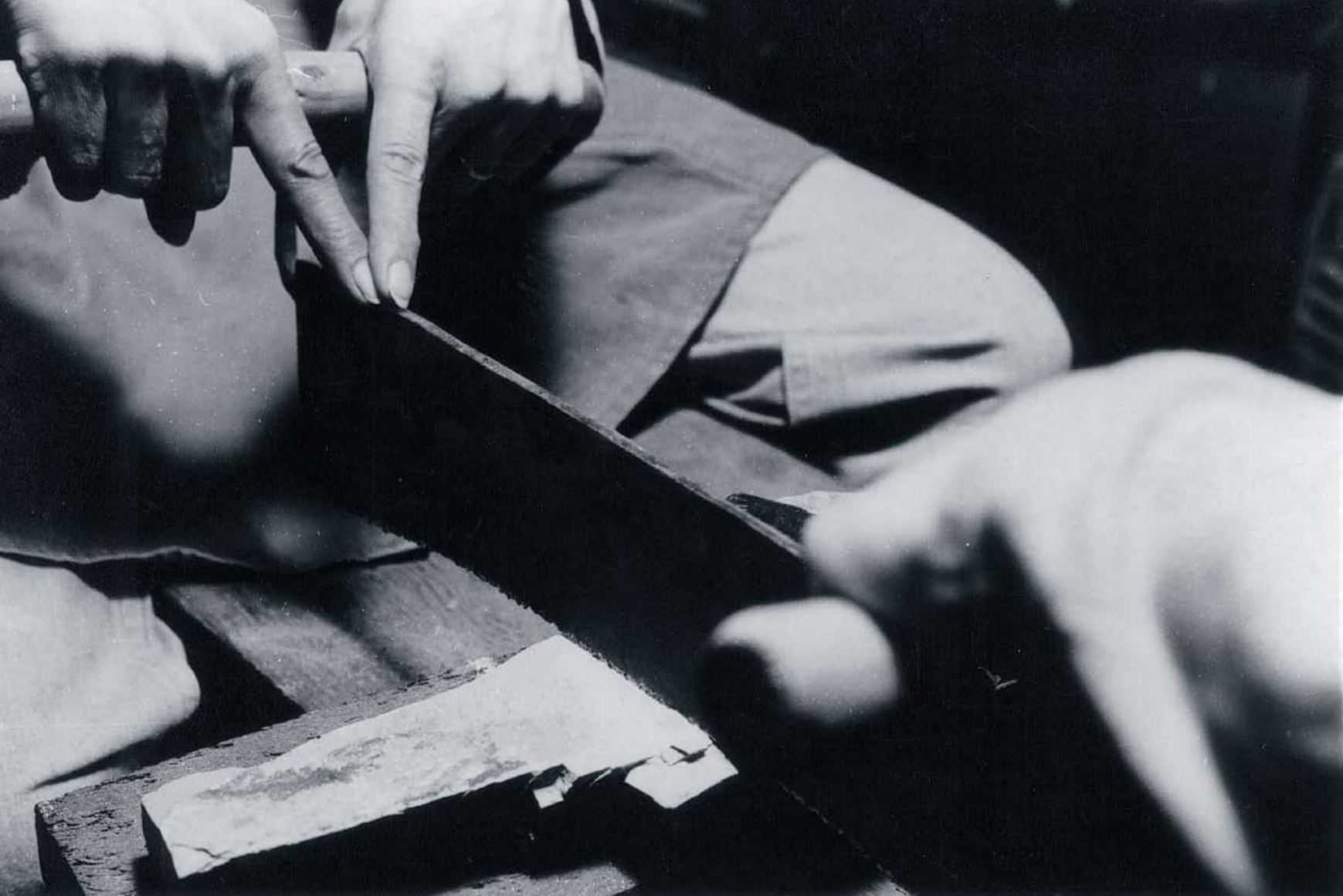
Détail du geste technique nécessaire pour scier un bloc de coticule à la scie à la main. Photo A. Lejeune. Collection privée.
