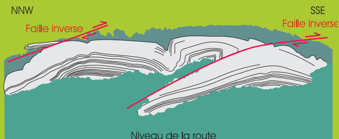
Rochers de Chamia avec localisation des deux failles de chevauchement.
