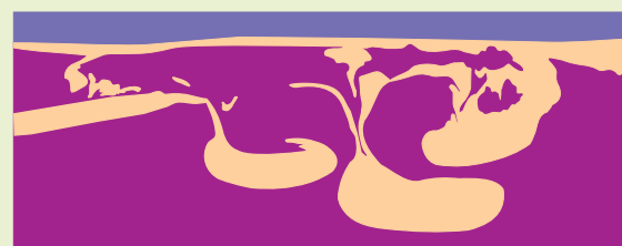
Les corps sableux à moitié individualisés s'enfoncent petit à petit, par gravité, dans la couche d'argile, plus plastique.
