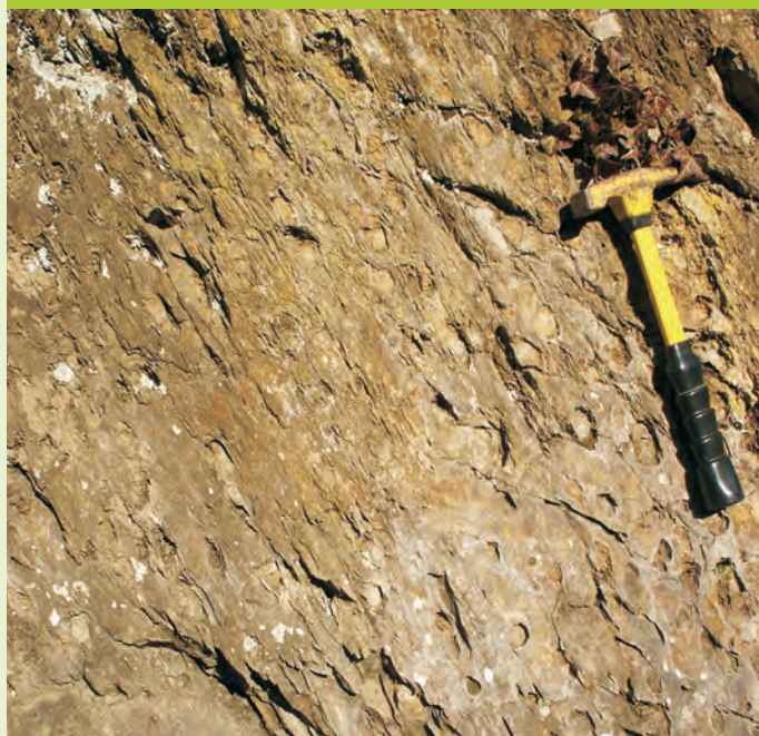
Schistes à nodules calcaires de la Formation de Barvaux. Noter que la schistosité (parallèle au manche du marteau) est plus redressée que la stratification (bien marquée au niveau de la pointe du marteau).
