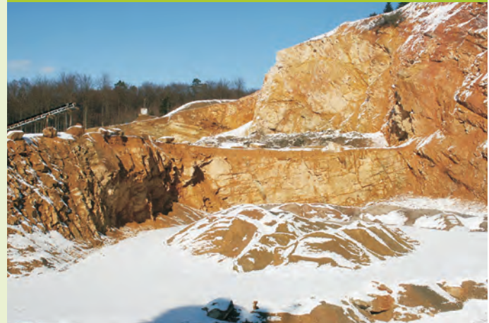
La carrière expose des grès dans la partie centrale et des phyllades sur le côté droit.
