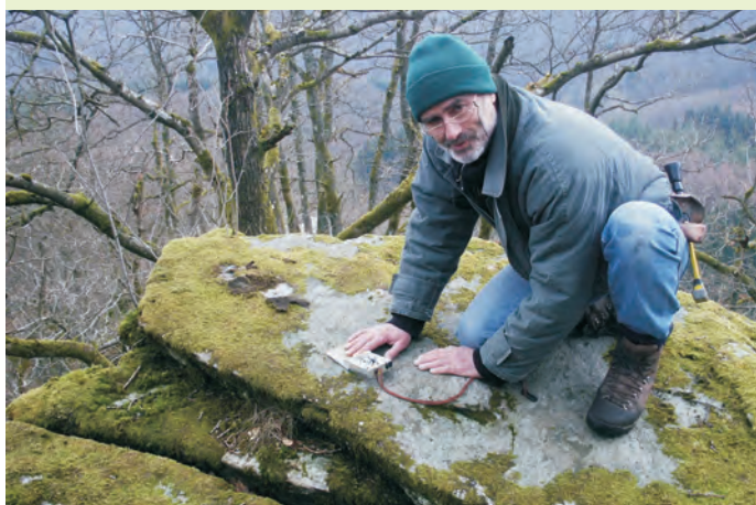
La mesure du pendage et de la direction des plans remarquables (stratification, schistosité, diaclases, etc.) se fait à l'aide d'une boussole spéciale.
