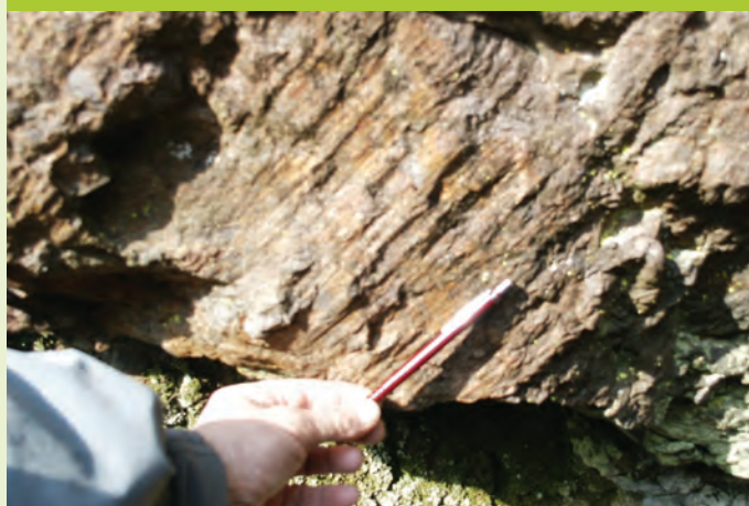
Stries de glissement sur un plan de fracture qui a séparé deux blocs de conglomérat. Ceux-ci se sont déplacés parallèlement au porte-mine.
